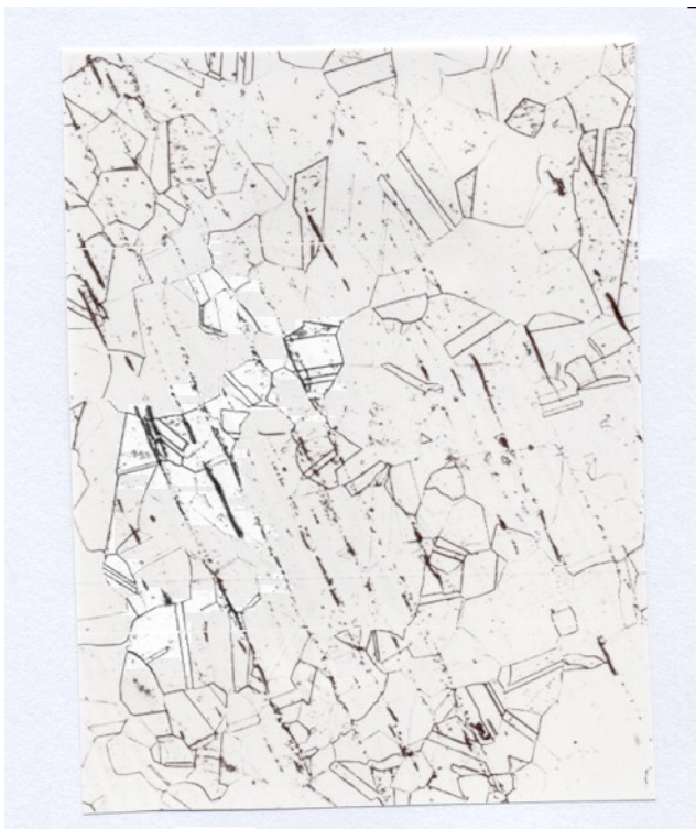
Bild 1. 100x Gefügebild im Randbereich.
